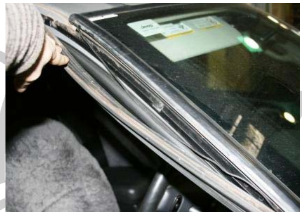
3.46 Peel off the door rubber seal
